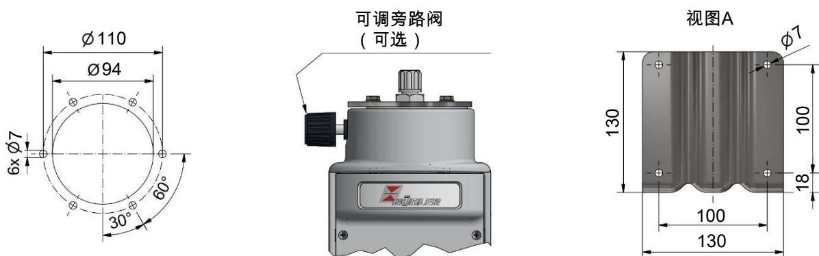
用于带中间法兰的泵的墙面安装图
