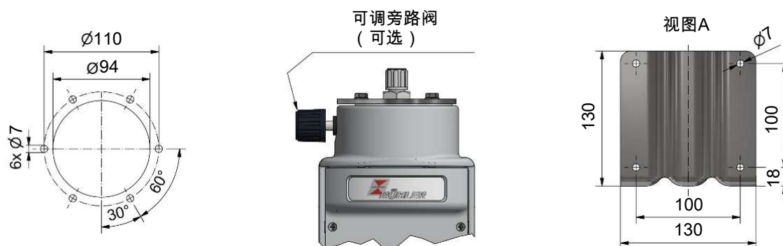
用于带中间法兰的泵的墙面安装图
