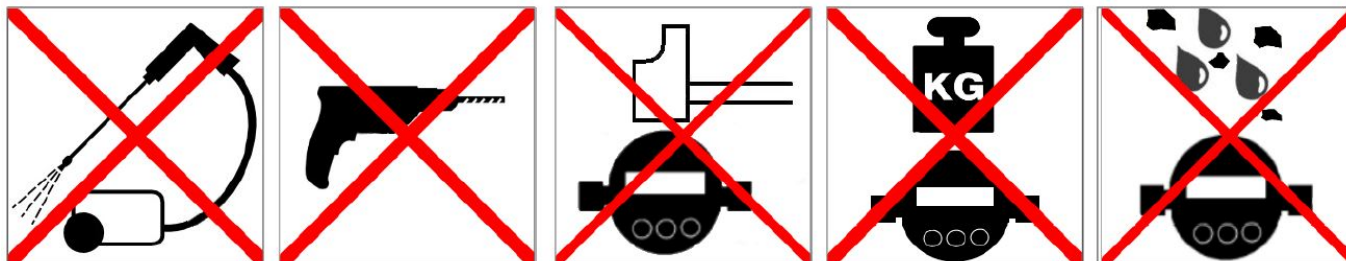
Abb. 8: Unzulässige mechanische Beanspruchung
