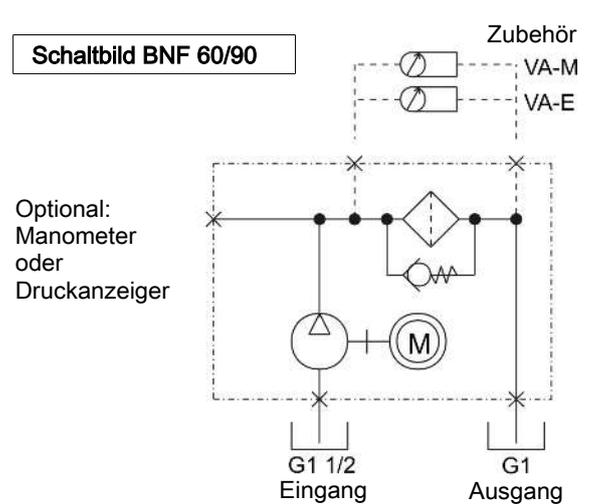
Der hydraulische Anschluss ist, wie im Schaltbild beschrieben, durchzuführen. Die Leitungen sind spannungs- und vibrationsfrei, in der Regel also über Schläuche anzuschließen.
