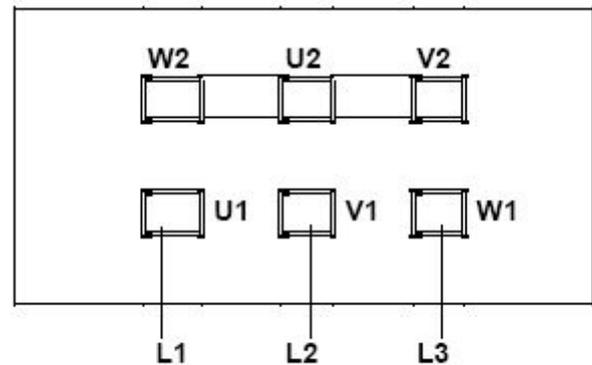
Eine Änderung der Drehrichtung wird durch das Umwecheln von zwei beliebigen Phasen herbeigeführt.
