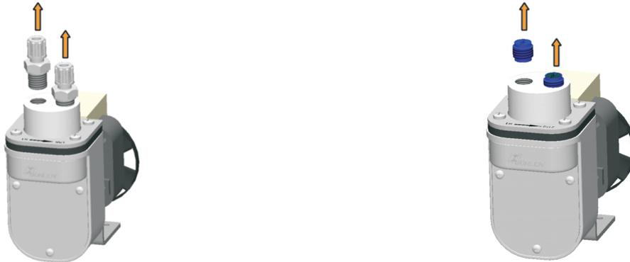
Demontieren Sie zunächst die Einschraubverschraubungen.
