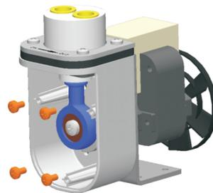
Lösen und entfernen Sie die 4 Torx-Schrauben (M4x6) der Pumpenkonsole (Torx T20).
