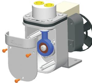
Lösen Sie die 3 Torx-Schrauben (M3x8) des Konsolendeckels (Torx T10).
