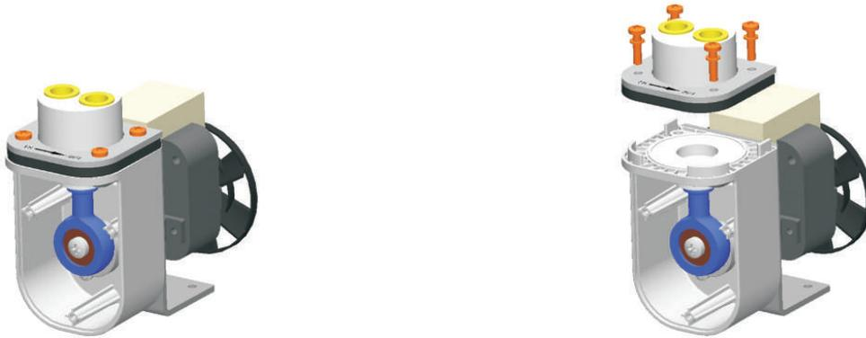
Demontieren Sie zunächst den Konsolendeckel wie in Kapitel „Umbau hängender Pumpenkörper“ beschrieben.
