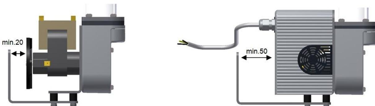
Bei der Montage der Messgaspumpe ist stets auf einen genügend großen Abstand des Motors von der Rückwand zu achten (20 mm).
