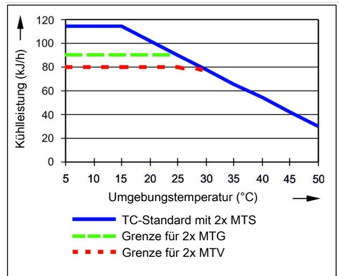
Anmerkung: Die Grenzkurven für die Wärmetauscher PTG, PTV bzw. MTV gelten bei einem Taupunkt von 40 °C.
