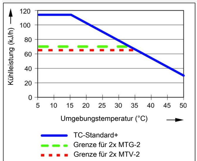
Anmerkung: Die Grenzkurven für die Wärmetauscher MTV-2 und MTG-2 gelten bei einem Taupunkt von 50 °C.
