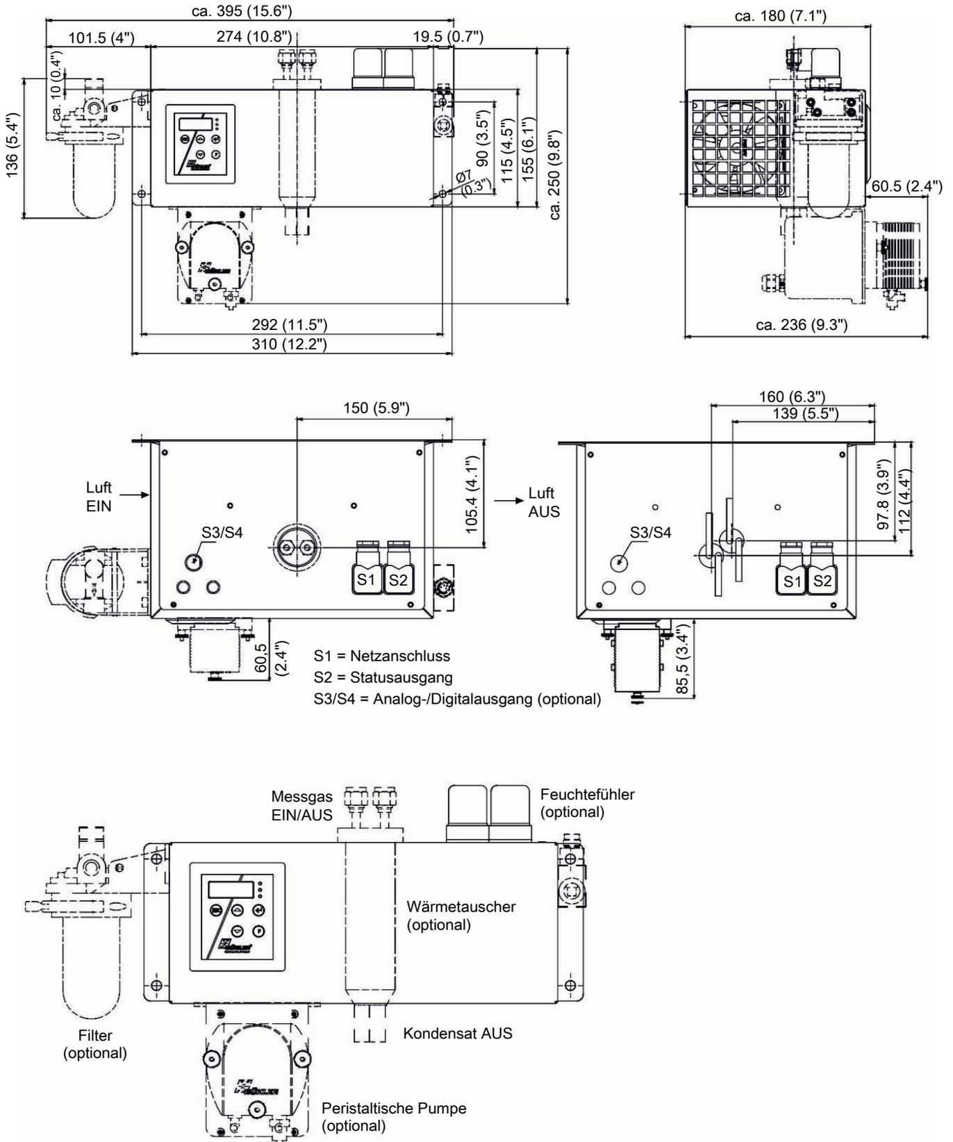
TC-Standard mit Wärmetauscher -H2/-O2
