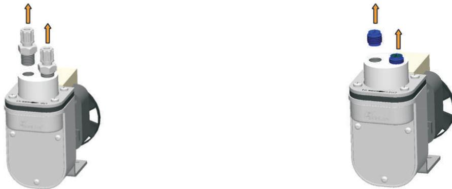
Demontieren Sie zunächst die Einschraubverschraubungen.
