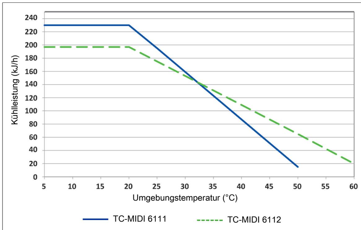
Anmerkung: Die Grenzkurven für die Wärmetauscher gelten bei einem Taupunkt von 50 °C.
