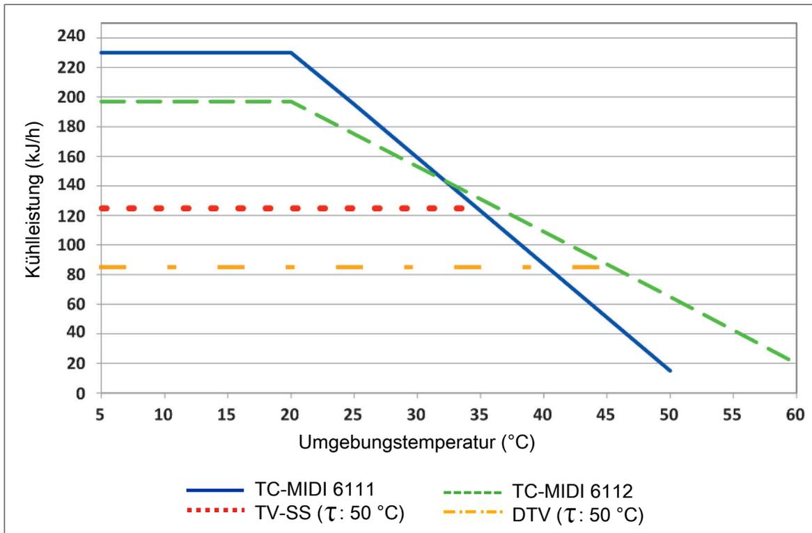
Anmerkung: Die Grenzkurven für die Wärmetauscher gelten bei einem Taupunkt von 50 °C.
