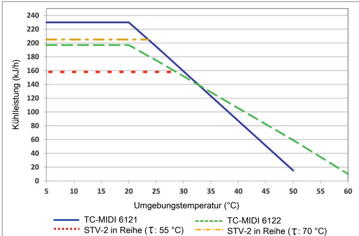
Anmerkung: Die Leistung der Wärmetauscher STG-2 ist mit der maximalen Kühlleistung des Kühlers gleichzusetzen.
