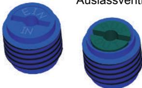
Zum Zusammenbau der Messgaspumpe führen Sie die Schritte in umgekehrter Reihenfolge durch. Beachten Sie beim Anziehen der Ein- und Auslassventile unbedingt das vorgeschriebene Einschraubdrehmoment von max. 1 Nm. **VORSICHT! Stärkeres Anziehen der Ventile bewirkt eine bleibende Verformung des Pumpenkörpers, welche einen Austausch zur Folge hätte.**
