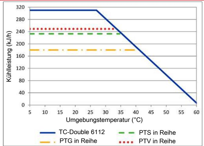
Anmerkung: Die Grenzkurven für die Wärmetauscher gelten bei einem Taupunkt von 50 °C.
