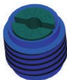
Zum Zusammenbau der Messgaspumpe führen Sie die Schritte in umgekehrter Reihenfolge durch. Beachten Sie beim Anziehen der Ein- und Auslassventile unbedingt das vorgeschriebene Einschraubdrehmoment von max. 1 Nm. **VORSICHT! Stärkeres Anziehen der Ventile bewirkt eine bleibende Verformung des Pumpenkörpers, welche einen Austausch zur Folge hätte.**
