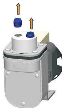
Demontieren Sie zunächst die Einschraubverschraubungen.
