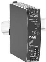
Das Redundanzmodul YR20.246 ist mit zwei Eingängen ausgestattet, die durch den Einsatz von MOSFET-Technik einzeln entkoppelt sind. Der Einsatz von MOSFETs anstelle von Dioden verringert die Wärmeentwicklung und den Spannungsabfall zwischen Eingang und Ausgang. Das YR20.246 benötigt keine zusätzliche Hilfsspannung und ist selbst bei einem Kurzschluss am Ausgang energieautark.
