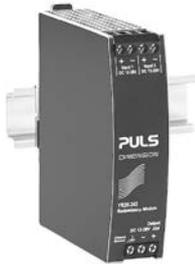
Das Redundanzmodul YR20.242 ist mit zwei Eingängen ausgestattet, die durch den Einsatz von MOSFET-Technik einzeln entkoppelt sind. Der Einsatz von MOSFETs anstelle von Dioden verringert die Wärmeentwicklung und den Spannungsabfall zwischen Eingang und Ausgang. Das YR20.242 benötigt keine zusätzliche Hilfsspannung und ist selbst bei einem Kurzschluss am Ausgang energieautark.
