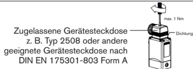
Bild 3: Elektrischer Anschluss der Gerätesteckdose
