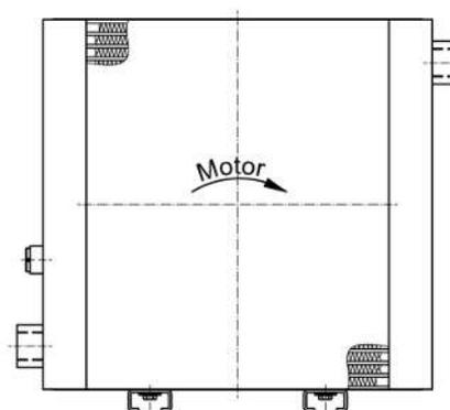
Sur la batterie de refroidissement, l'entrée d'huile est située sur la gauche. La sortie d'huile est toujours située sur le côté opposé.
