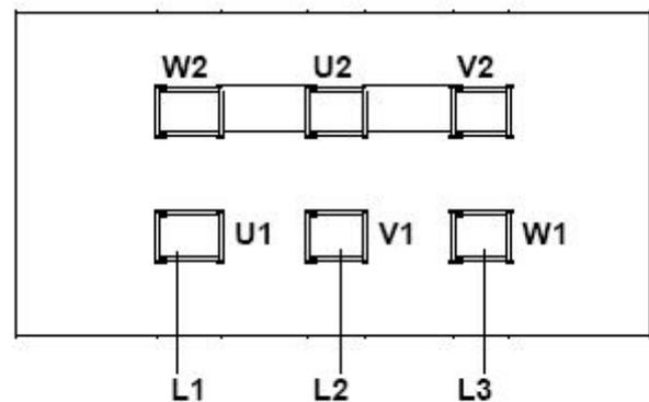
Un changement du sens de rotation est provoqué par l'inversion de deux phases quelconques.
