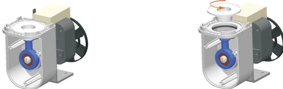
Pour changer le soufflet, dévissez-le avec précaution du coulisseau en le tournant dans le sens inverse des aiguilles d'une montre. Faites attention à ne pas perdre les éventuelles rondelles d'ajustement.
