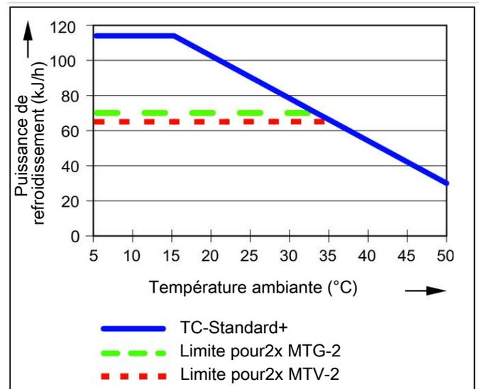
Remarque : Les courbes limites pour les échangeurs thermiques MTV-2 et MTG-2 s'appliquent pour un point de rosée de 50 °C.
