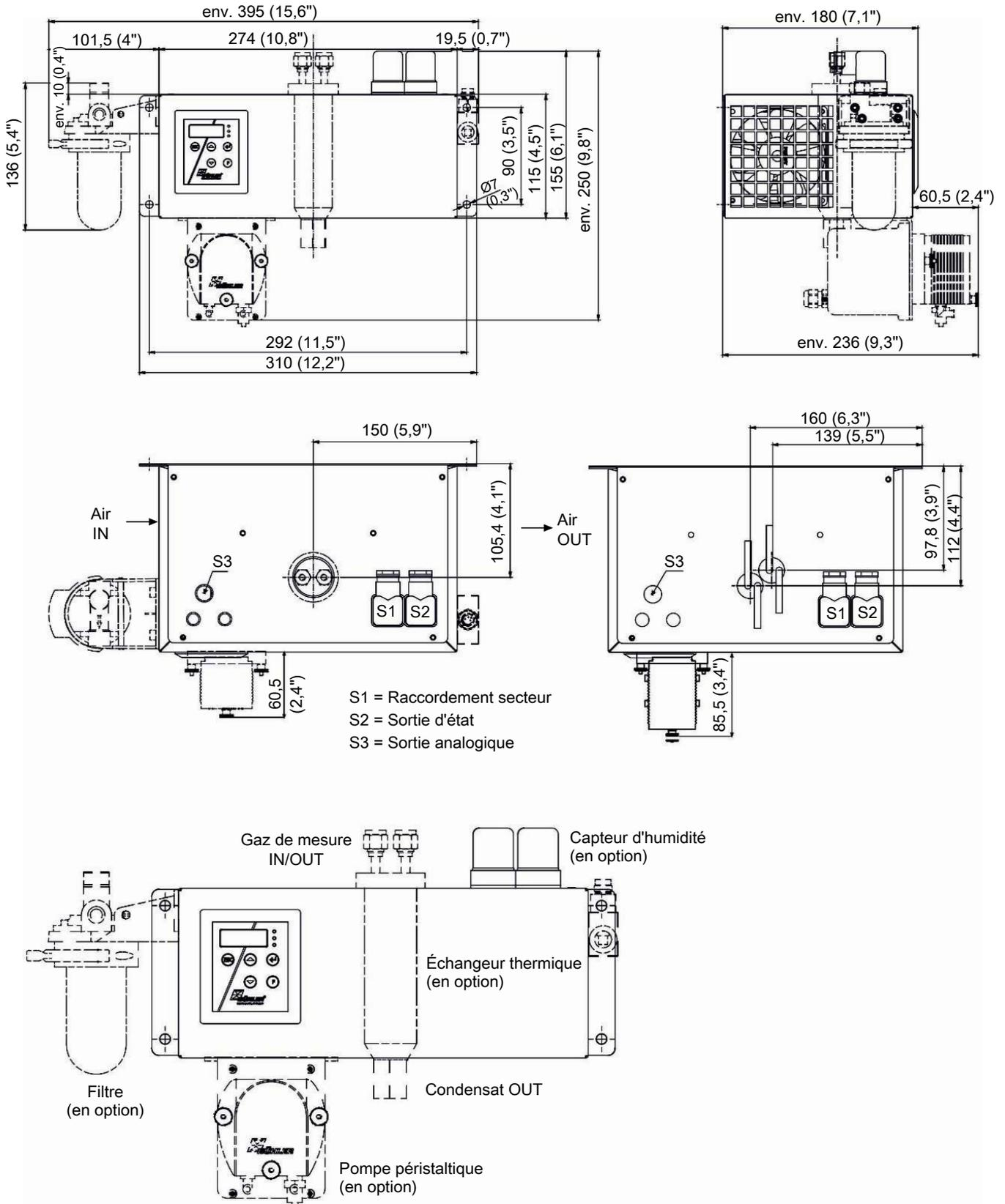
TC-Standard avec échangeur thermique -H2/-O2
