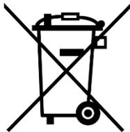
Символ перечеркнутого мусорного бака указывает на то, что отмеченные им электрические и электронные изделия должны утилизироваться отдельно от бытовых отходов. Они должны быть надлежащим образом утилизированы как электрическое и электронное оборудование.
