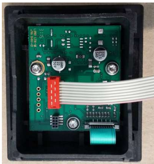
Монтаж дисплея, плоский кабель
