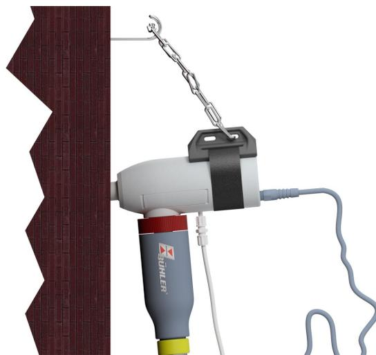
Зонд необходимо закрепить на месте забора с помощью подходящих мер, так как работа руками не допускается из-за высоких температур поверхности. Мы рекомендуем подвесить его с помощью монтажного кронштейна и цепи (см. изображение; опционально доступны в качестве комплектующих).
