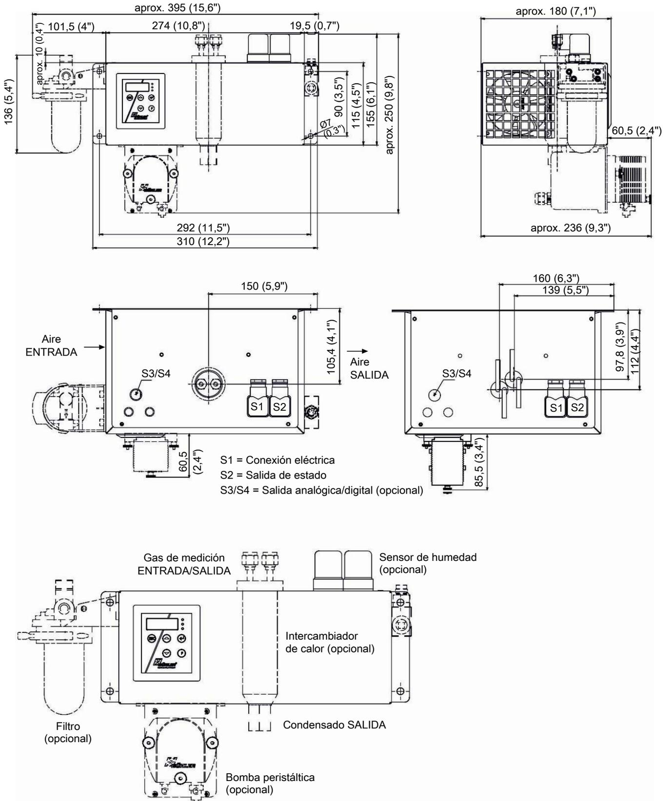
TC-Standard con intercambiador de calor -H2/-O2
