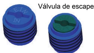
Para el montaje de la bomba de gases de muestreo siga los pasos en el orden inverso. Tenga en cuenta al apretar las válvulas de entrada y salida el par de apriete descrito de máx. 1 Nm. **CUIDADO! Apretar las válvulas demasiado fuerte produce una deformación permanente del cuerpo de la bomba, lo que supone el reemplazo de este.**
