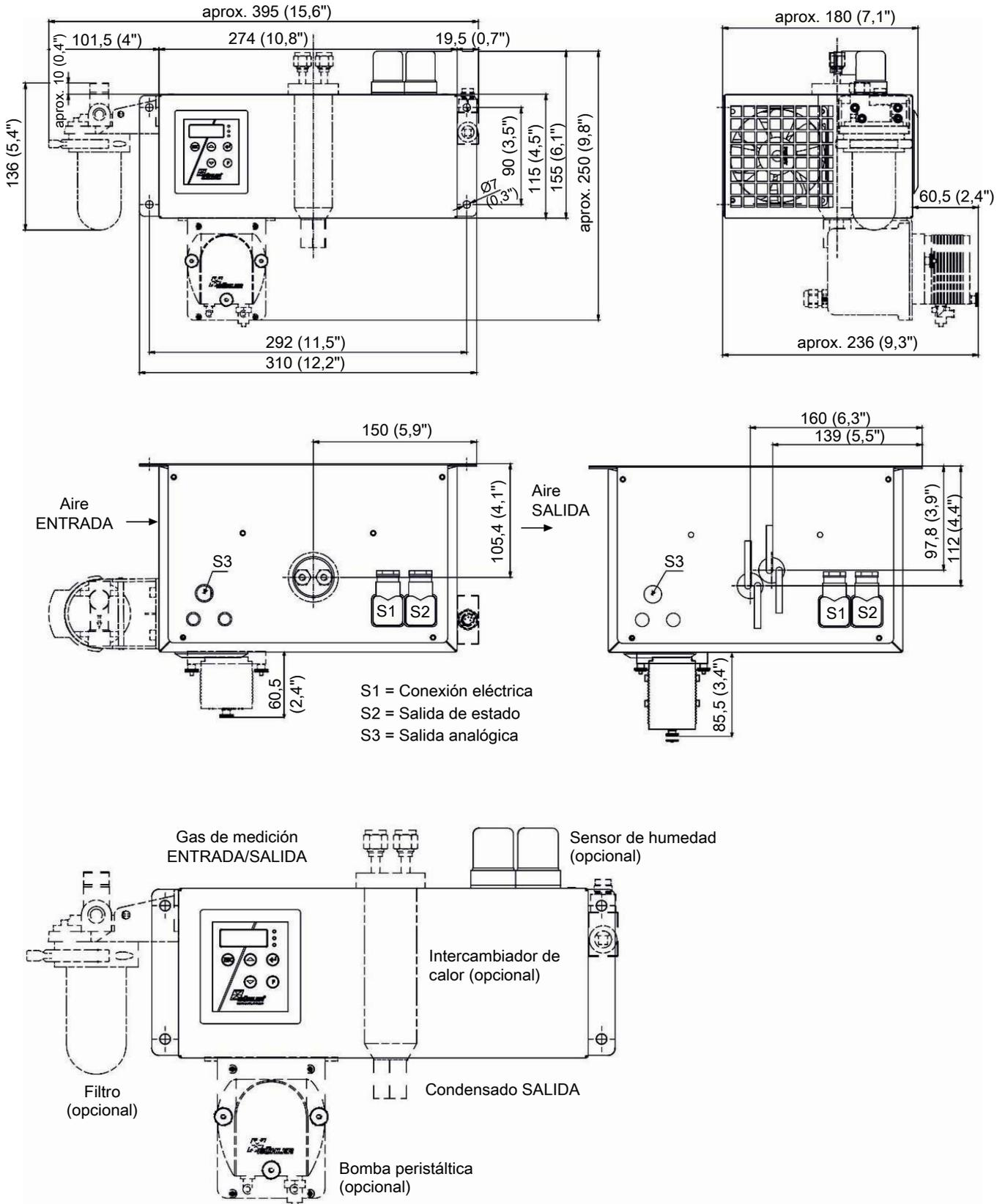
TC-Standard con intercambiador de calor -H2/-O2
