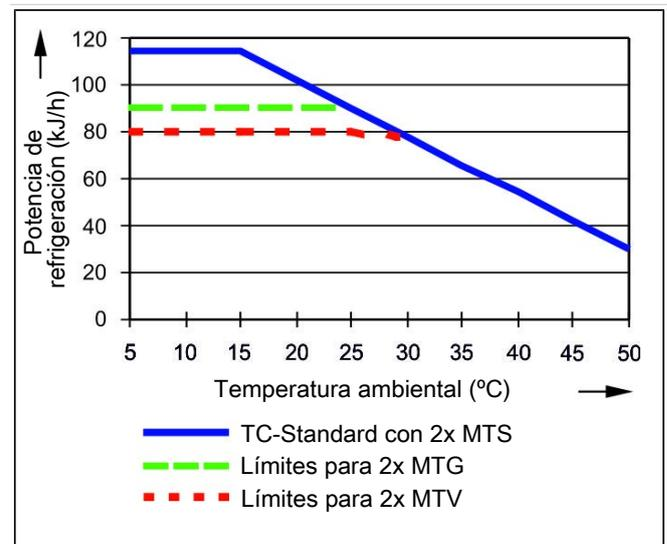
**TC-Standard con intercambiador de calor -H2/-O2**
