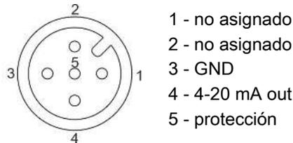
\* En caso de utilizar la salida de estado con tensión  $\geq 33$  V CA o  $\geq 70$  V CC PE, se debe conectar el conductor de protección (PE). La zona de sujeción tiene un diámetro de 8-10 mm (0,31 – 0,39 pulgadas).
