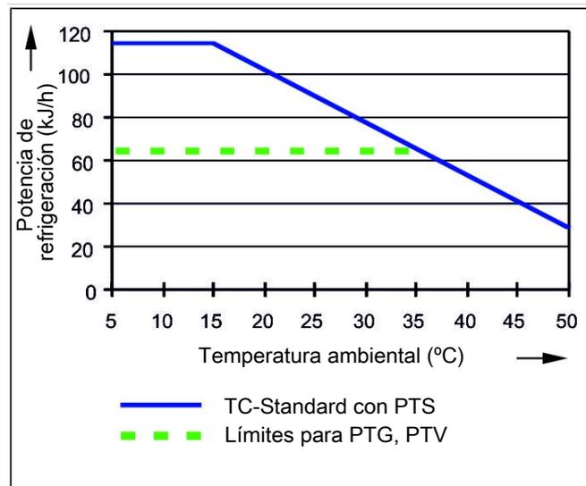
Observación: Las curvas límite para los intercambiadores de calor PTG, PTV y MTV son aplicables con un punto de condensación de 40 °C.
