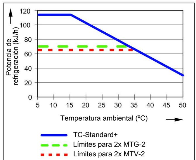
Observación: Las curvas límite para los intercambiadores de calor MTV-2 y MTG-2 son aplicables con un punto de condensación de 50 °C.
