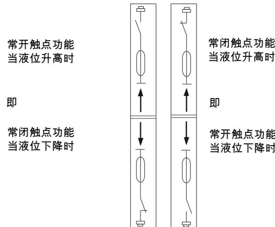
触点逻辑假定,液位开关安装在一空罐中,即灌装后才在工作位置。
