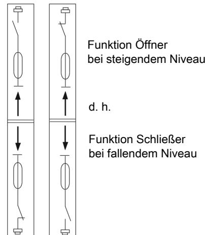
Die Kontaktlogik geht davon aus, dass der Niveauschalter in einen leeren Tank installiert wird, d. h. er ist erst nach dem Befüllen in der Betriebsposition.
