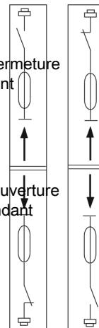
Fonction de contact à fermeture lors d'un niveau croissant
