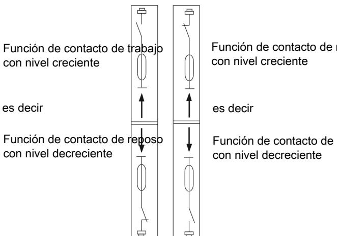
La lógica de contacto parte de la base de que el interruptor de nivel se instala en un recipiente vacío, por lo tanto, no se encuentra en la posición de funcionamiento hasta después del llenado.
