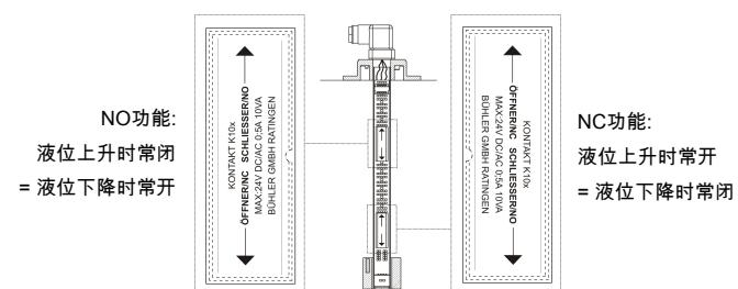
触点逻辑假定，液位开关安装在一空罐中，即灌装后才在工作位置。
