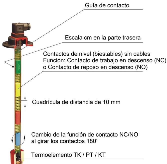
Los contactos accionados del flotador se han colocado con tornillos de plástico en una guía de contacto dorada galvanizada con escala cm. Las carcasa de contactos son de diferentes colores y solo pueden montarse en el siguiente orden en la guía de contacto.
