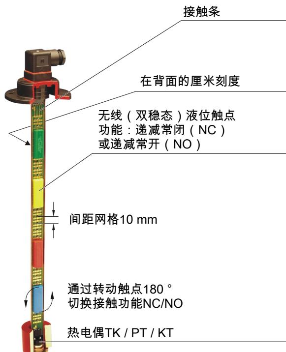
借助塑料螺丝，由浮子致动的触点被安装在刻度为厘米的镀金接触条上。触点外壳被设计成各种颜色，只能按照以下顺序被安装在接触条上。
