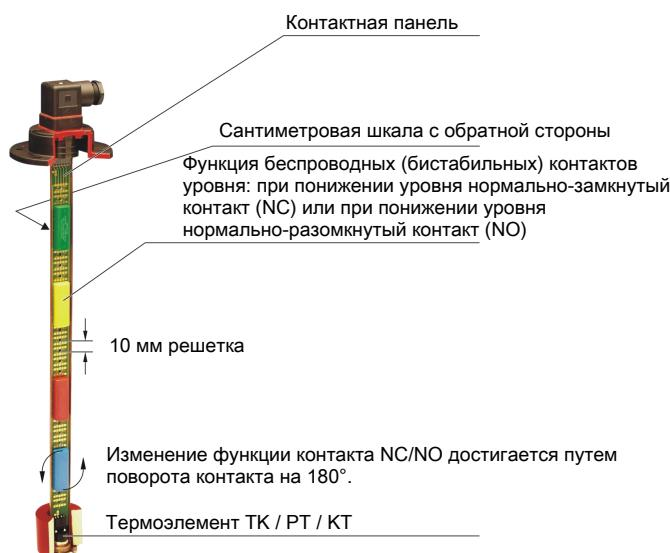
Управляемые поплавком контакты при помощи пластмассовых винтов установлены на гальванически позолоченной контактной панели с сантиметровой шкалой. Корпуса контактов имеют разные цвета и могут монтироваться на контактной панели только в следующем порядке.
