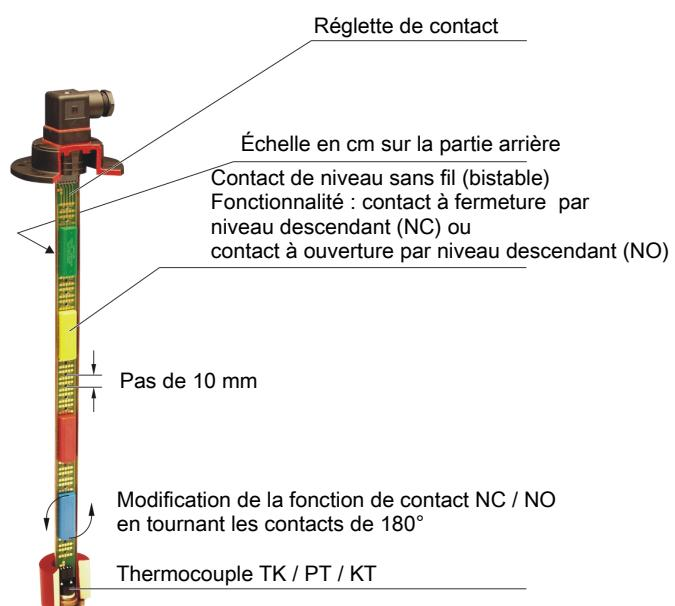
Les contacts actionnés par le flotteur sont montés avec des vis en plastiques sur une réglette de contacts à dorure galvanique avec échelle en cm. Les boîtiers de contact sont de couleur différente et ils ne doivent être montés sur la réglette de contacts que dans l'ordre suivant.
