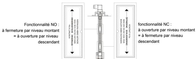
La logique de contact suppose que l'interrupteur de niveau est installé dans un réservoir vide, ce qui signifie sa mise en service après avoir été rempli.
