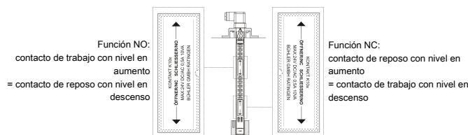
La lógica de contacto parte de la base de que el interruptor de nivel se instala en un depósito vacío, es decir, después de llenarlo en la posición de funcionamiento.
