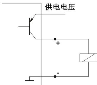
**提示：** 当以高阻抗的测量装置输入来测量开关量输出或用作频率输出时，应在输出端和接地线（GND）之间接入10 kΩ电阻，以防止测量错误。
