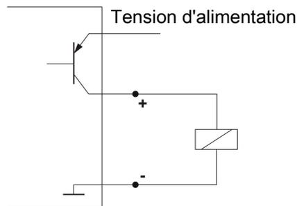
**Indication :** Lors de mesures de sortie de commutation avec des entrées d'appareils de mesure de valeur ohmique élevée ou lors de l'utilisation comme sortie de fréquence, une résistance de 10 kΩ doit être branchée entre la sortie et la masse (GND) afin de prévenir les mesures erronées.
