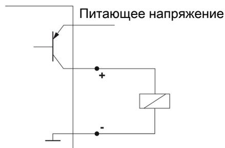
**Указание:** При измерениях переключающего выхода с высокоомными входами измеряемых приборов или при использовании в качестве частотного выхода во избежание ошибочных измерений необходимо подключить сопротивление 10 k $\Omega$  между выходом и массой (GND).
