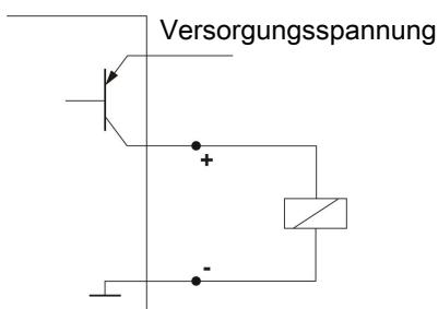
**Hinweis:** Bei Messungen des Schaltausgangs mit hochohmigen Messgeräteeingängen oder bei Nutzung als Frequenzausgang ist ein 10 kΩ Widerstand zwischen Ausgang und Masse (GND) zu schalten, um Fehlmessungen vorzubeugen.
