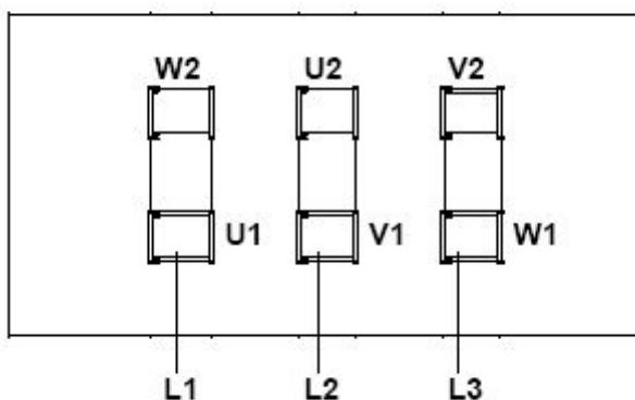
Eine Änderung der Drehrichtung wird durch das Umwechseln von zwei beliebigen Phasen herbeigeführt.
