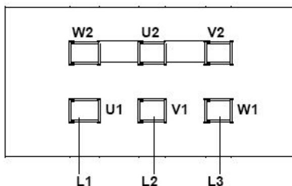
Un changement du sens de rotation est provoqué par l'inversion de deux phases quelconques.
