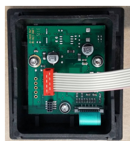
Montaje de pantalla, cable de cinta
