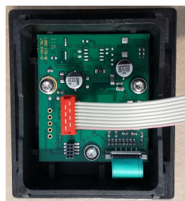
Montage Anzeige, Flachbandkabel
