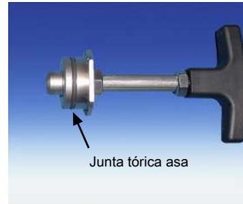
Colocar una junta tórica apta para la temperatura ambiental estimada en el mango.
