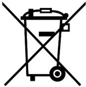
被划掉的垃圾桶的符号表示标有它的电器电子产品必须与生活垃圾分开处理。必须作为废弃的电气和电子设备妥善处理它们。
