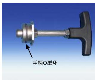
在手柄上放置一个适合预期环境温度的O型环（参见“替换件与备件”一章）。将排气过滤器连接到手柄上。然后小心地将带过滤器的手柄插入气体采样探头，并旋转90°将其固定。
