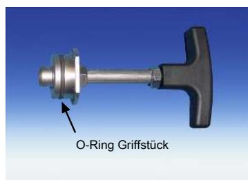
Einen für die zu erwartende Umgebungstemperatur geeigneten O-Ring auf das Griffstück einsetzen (siehe Kapitel „Ersatz- und Zusatzeile“).
