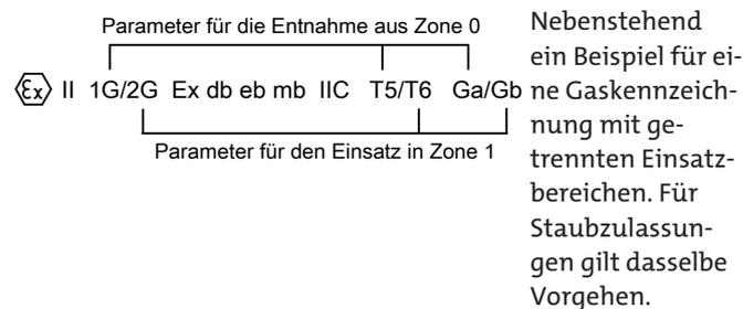
Beachten Sie, dass die Temperaturklasse für die Entnahmezone 0 im Gegensatz zur Betriebszone reduziert ist. Dies ist auch an der Zündschutzkennzeichnung auf dem Typenschild ersichtlich.
