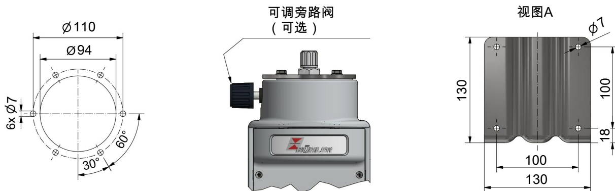
用于带中间法兰的泵的墙面安装图
