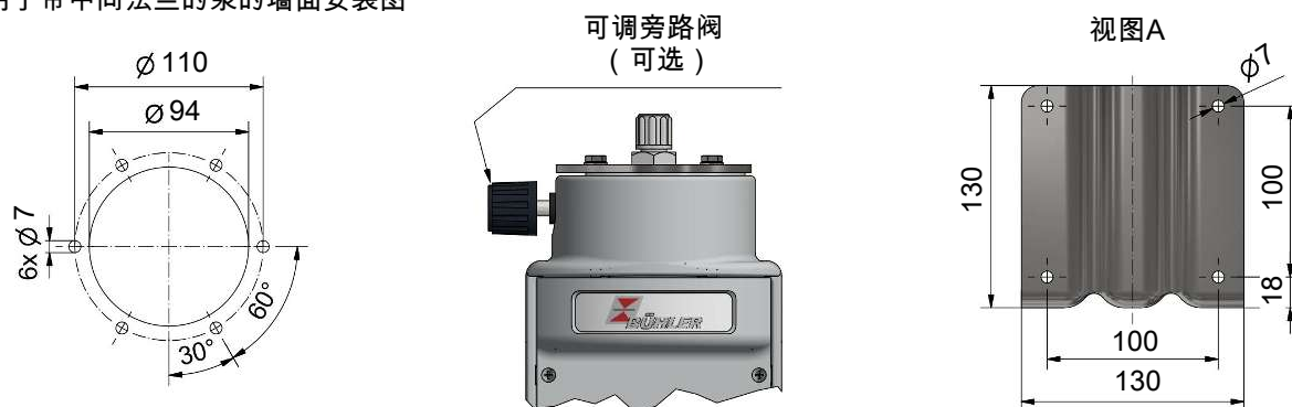
用于带中间法兰的泵的墙面安装图
