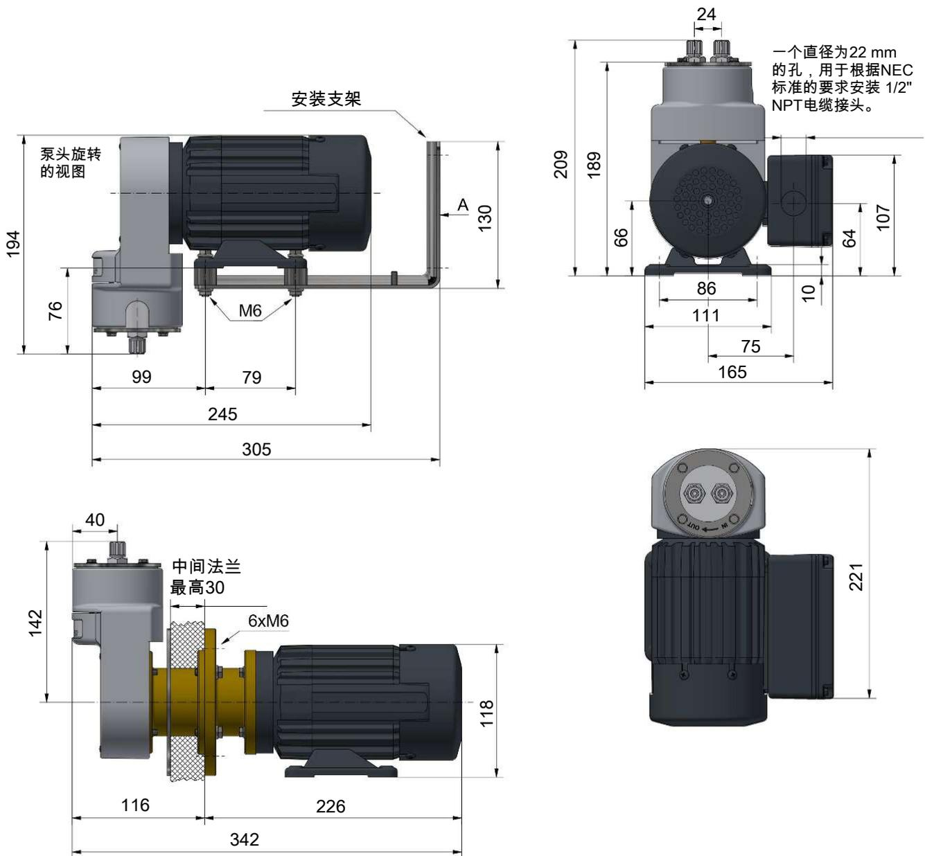
用于带中间法兰的泵的墙面安装图
