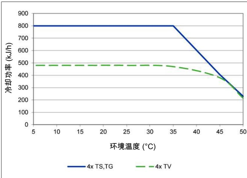
注释：换热器的极限曲线适用于65 ° C的露点下。
