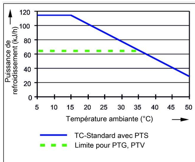
Remarque : Les courbes limites pour les échangeurs thermiques PTG, PTV ou MTV s'appliquent pour un point de rosée de 40 °C.
