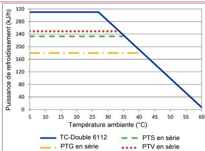
Remarque : Les courbes limites pour les échangeurs thermiques s'appliquent pour un point de rosée de 50 °C.
