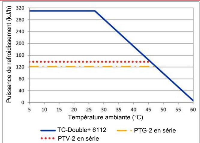
Remarque : Les courbes limites pour les échangeurs thermiques s'appliquent pour un point de rosée de 50 °C.
