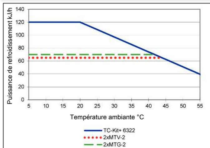
Remarque : Les courbes limites pour les échangeurs thermiques MTV-2 et MTG-2 s'appliquent pour un point de rosée de 50 °C.
