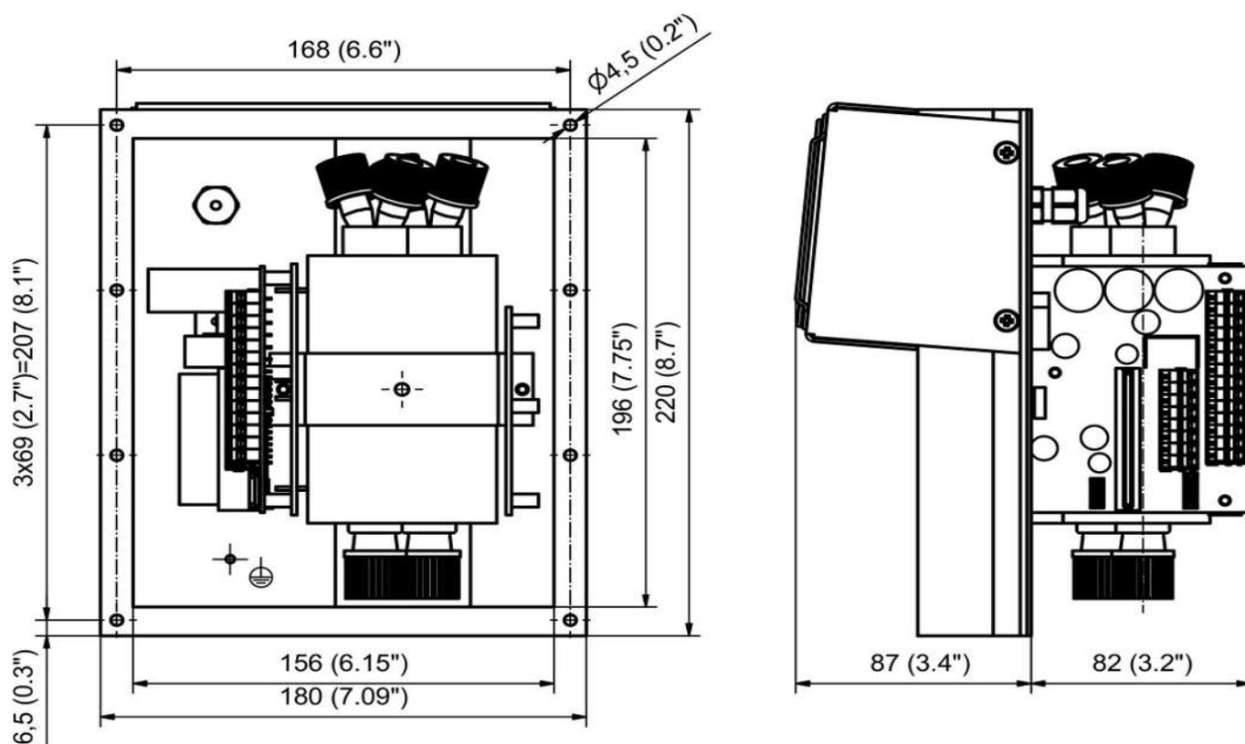
Module d'extension et d'alimentation en tension
