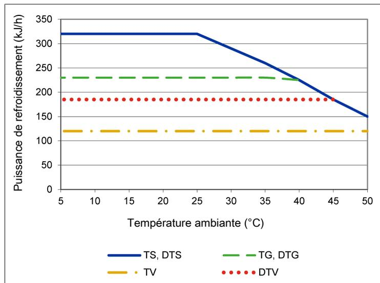
Remarque : Les courbes limites pour les échangeurs thermiques s'appliquent pour un point de rosée de 65 °C.
