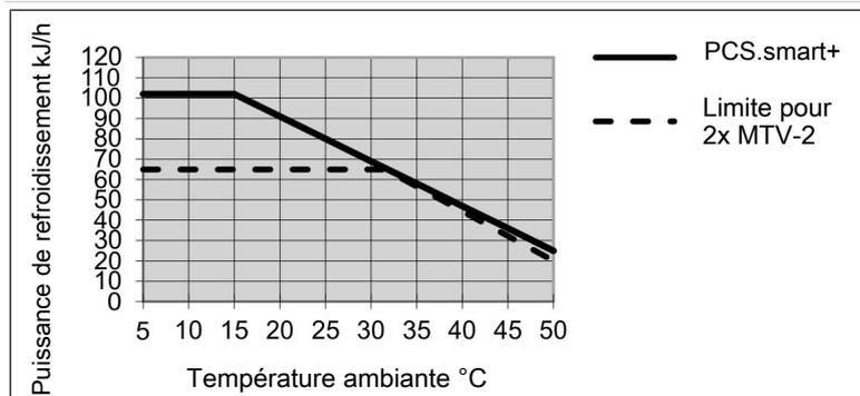
Remarque : La courbe limite pour l'échangeur thermique s'applique pour un point de rosée de 50 °C.
