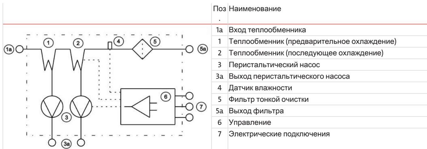
Подготавливаемый газ подается непосредственно на вход теплообменника (1, 1a). Выход теплообменника (2) предварительно соединен шлангом с фильтром тонкой очистки (5). Последующая подача анализируемого газа осуществляется непосредственно перед выходом такого фильтра при помощи шлангового соединения (5a).
