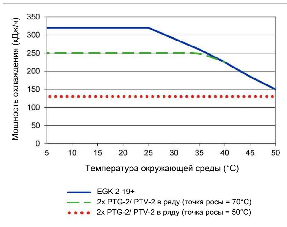
Примечание: Граничные кривые для теплообменников действительны при точке росы 70 °С в нормальных условиях согласно DIN EN 15267-3:2008-03 и при точке росы 50 °С при условиях эксплуатации.
