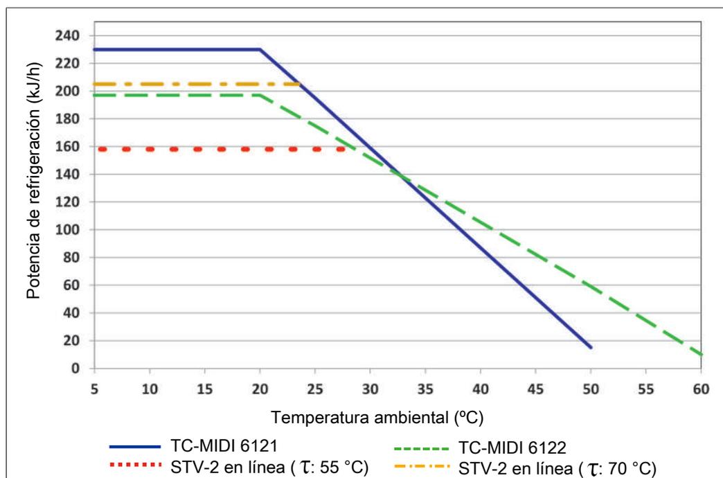
Observación: La potencia del intercambiador de calor STG-2 debe igualarse a la potencia de enfriamiento máxima del refrigerador.
