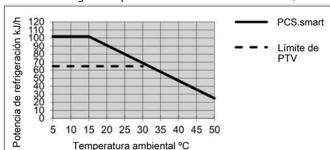
Observación: La curva límite para los intercambiadores de calor es aplicable con un punto de condensación de 40° C.
