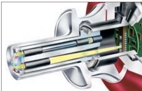
Alle Bauteile sind im stabilen CORE-Optik Modul integriert. Die patentierte CORE-Optik sorgt für eine mechanische Entkoppelung von externen Einflüssen und Vibrationen. Die CORE-Optik kommt ohne jegliche mechanische Einstellungen aus.
